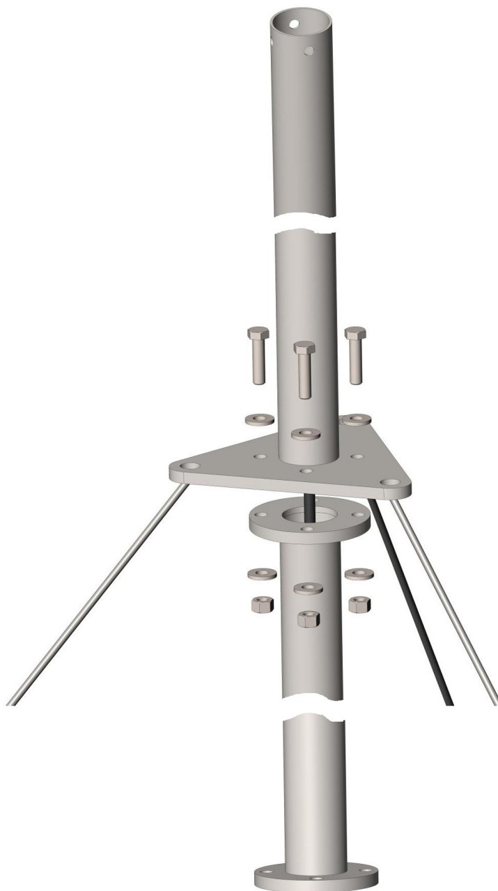
Рис. 6 Сборка 3-ой секции опоры ветроуказателя.
